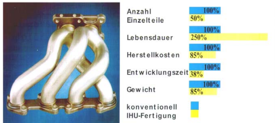
Abb. 3.2: Verbesserungen an einem Abgassystem [19]
