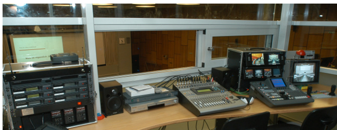
Regieraum: Mikrofonempfänger, Audio- und Videomischung, Vorschaumonitor, Bedienpanel der Kamerasteuerung
