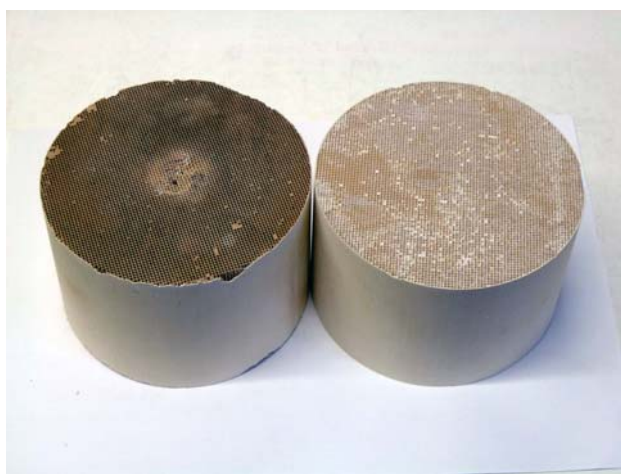
Abbildung 75: Ein frisch beschichteter Monolith (rechts) im Vergleich zu einem Monolithen, der für einen Langzeitversuch mit Aceton-Zugabe in großen Mengen genutzt wurde.
