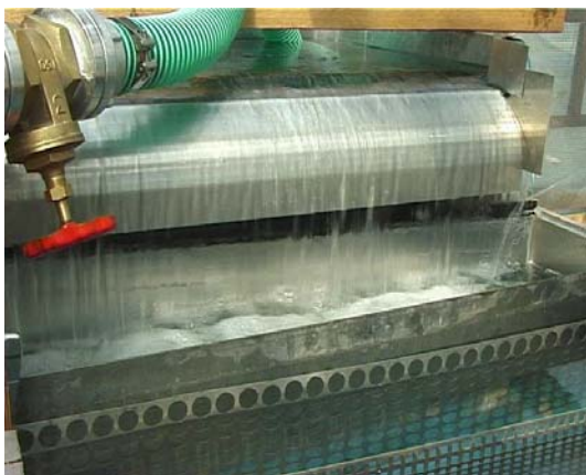
Abbildung 24: Zusätzliches Tosbecken im Hintergrund und Tosbecken im Vordergrund
