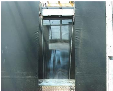
Abbildung 72: Wasserschleier bei 5 l/s
