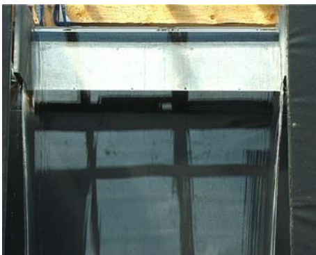
Abbildung 77: Detail - Wasserschleier bei 7 l/s
