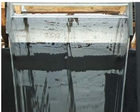
Abbildung 54: Detail - Überlaufkörper mit Achtelkreis, r= 200 mm
