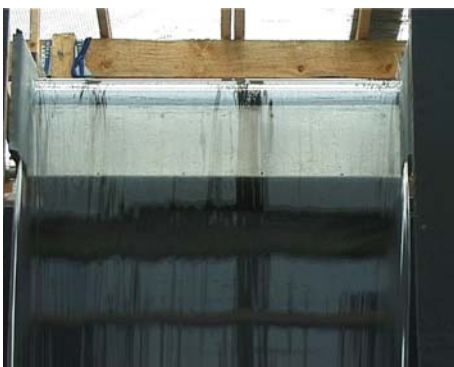
Abbildung 93: Detail - Wasserscheier bei 15 l/s
