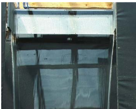
Abbildung 73: Detail - Wasserschleier bei 5 l/s
