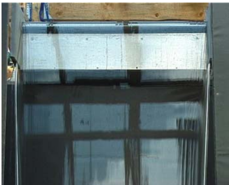
Abbildung 83: Detail – Wasserschleier bei 10 l/s
