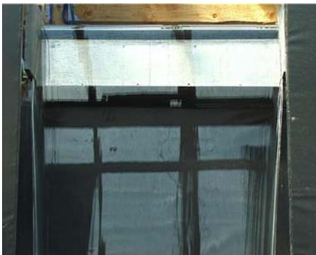
Abbildung 79: Detail - Wasserschleier bei 8 l/s
