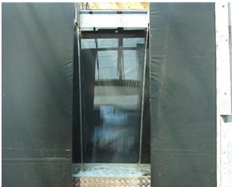
Abbildung 76: Wasserschleier bei 7 l/s
