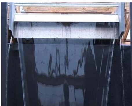
Abbildung 50: Detail - Überlaufkörper mit Viertelkreis, r=100 mm
