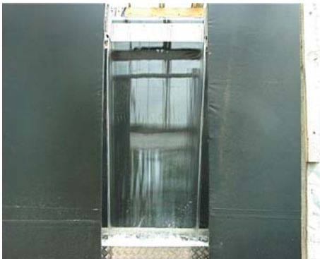
Abbildung 88: Wasserschleier bei 13 l/s
