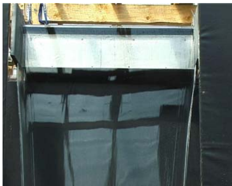
Abbildung 71: Detail - Wasserschleier bei 4 l/s
