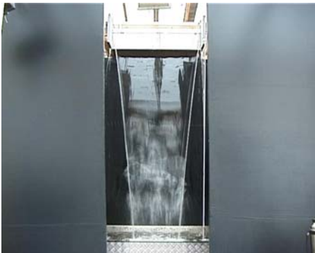
Abbildung 61: Überlaufkörper mit 30° Winkel, L=50 mm
