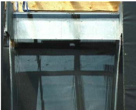
Abbildung 75: Detail - Wasserschleier bei 6 l/s
