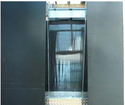
Abbildung 84: Wasserschleier bei 11 l/s
