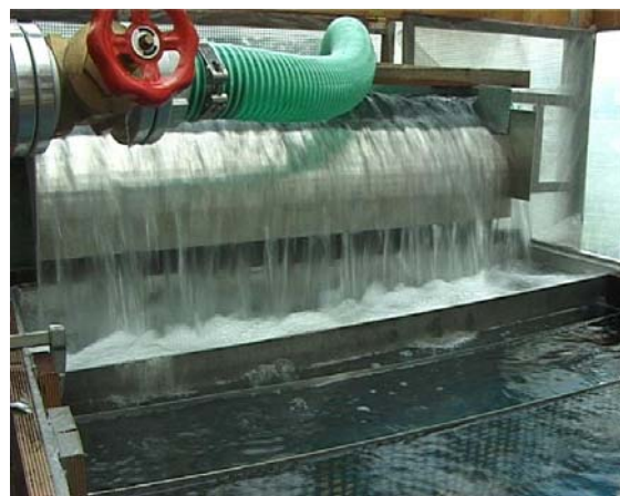
Abbildung 30: Überfluss ins Tosbecken bei 10 l/s
