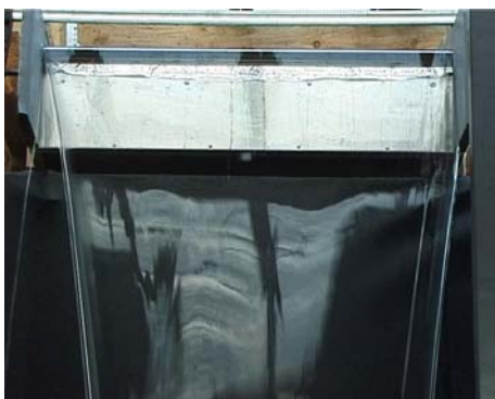
Abbildung 43: Detail - Überlaufkörper mit rechtem Winkel, L= 50 mm
