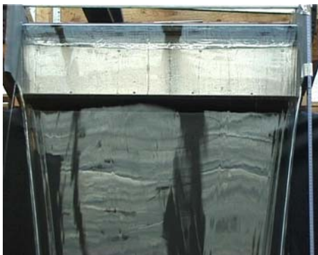
Abbildung 45: Detail – Überlaufkörper mit rechtem Winkel, L= 100 mm
