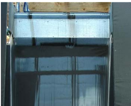
Abbildung 85: Detail - Wasserschleier bei 11 l/s
