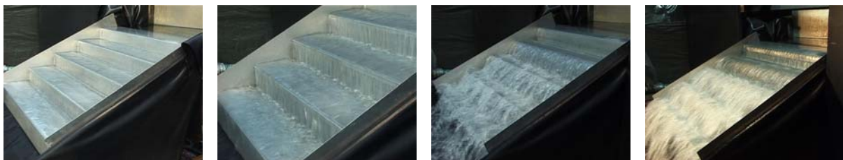
Abbildung 149: Bilderzyklus 4: Steigerung der Durchflussmenge an Proportion 2:1 bei 20° Neigung
