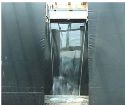
Abbildung 69: Detail - Wasserscheier bei 3 l/s
