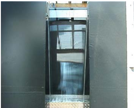
Abbildung 80: Wasserschleier bei 9 l/s
