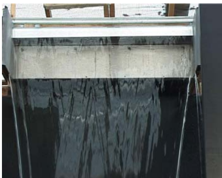
Abbildung 60: Detail - Überlaufkörper mit 15° Anlauf, r= 45 mm
