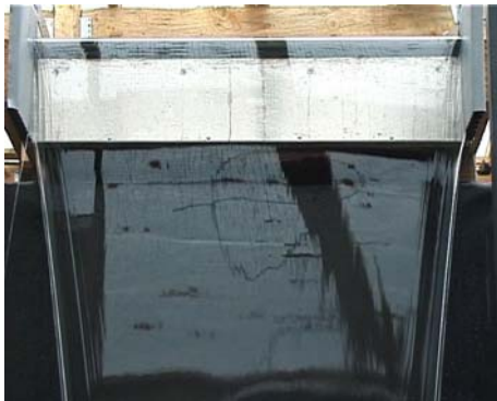
Abbildung 67: Detail - Wasserscheier bei 2 l/s
