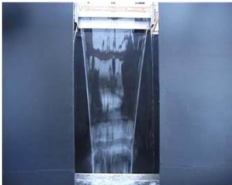
Abbildung 49: Überlaufkörper mit Viertelkreis, r=100 mm
