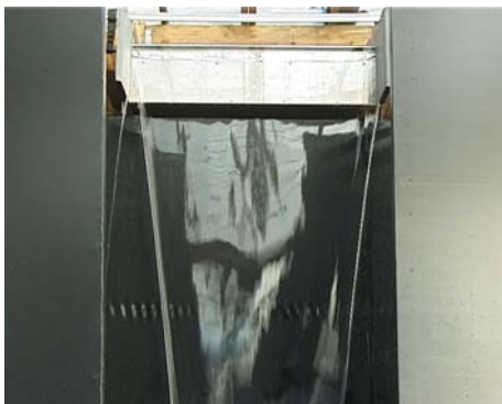
Abbildung 41: Detail - Überlaufkörper mit rechtem Winkel, L= 25 mm
