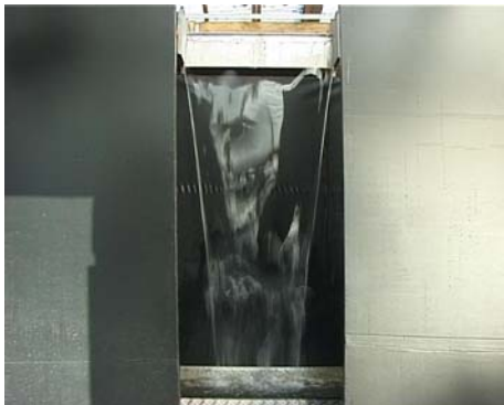
Abbildung 40: Überlaufkörper mit rechtem Winkel, L= 25 mm
