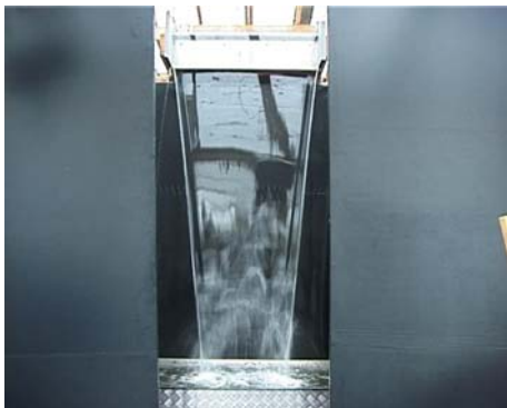
Abbildung 36: Überlaufkörper mit 20° Anlauf
