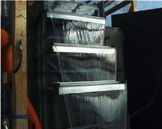
Abbildung 162: Kaskade mit 50 cm Fallhöhe und 1,5 l/s
