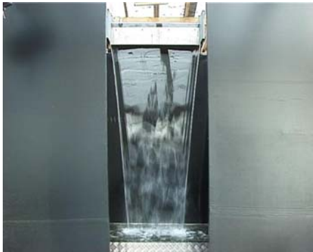
Abbildung 38: Überlaufkörper mit 30° Anlauf
