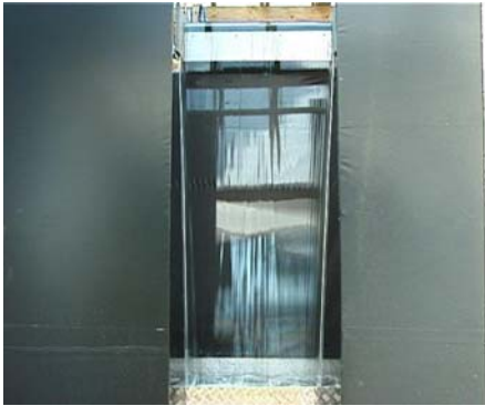
Abbildung 82: Wasserschleier bei 10 l/s
