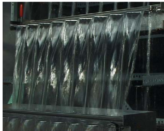
Abbildung 165: Detailaufnahme einer Kaskade mit strukturierten Wasserschleiern
