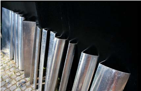
Abbildung 25: Überlaufkörper der Versuchsreihen ÜK (Überlaufkörper)
