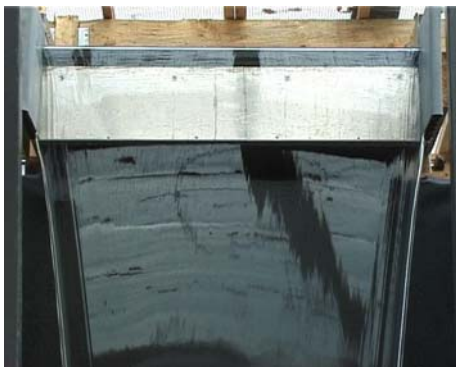
Abbildung 39: Detail - Überlaufkörper mit 30° Anlauf
