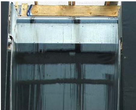
Abbildung 87: Detail - Wasserschleier bei 12 l/s
