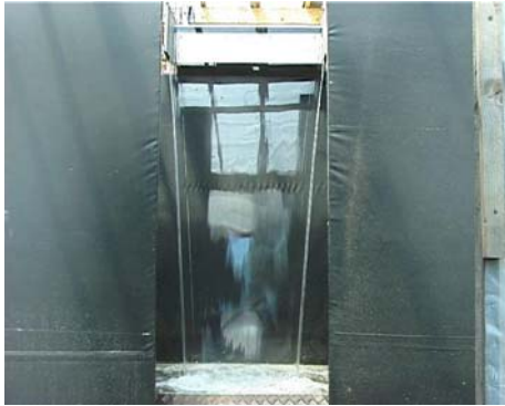
Abbildung 70: Wasserschleier bei 4 l/s
