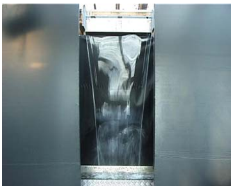
Abbildung 42: Überlaufkörper mit rechtem Winkel, L= 50 mm
