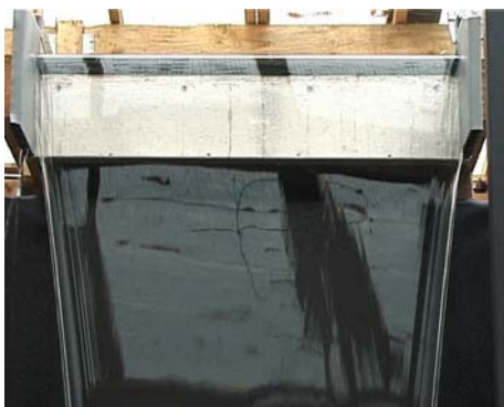
Abbildung 37: Detail - Überlaufkörper mit 20° Anlauf
