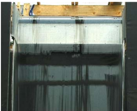
Abbildung 89: Detail - Wasserschleier bei 13 l/s
