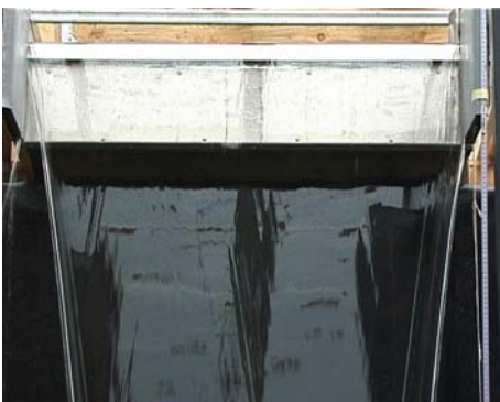
Abbildung 62: Detail - Überlaufkörper mit 30° Winkel, L= 50 mm
