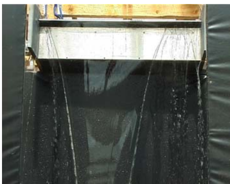
Abbildung 65: Detail - Wasserschleier bei 1 l/s
