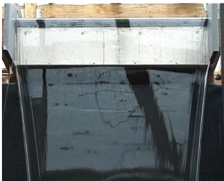
Abbildung 35: Detail - Überlaufkörper mit 10° Anlauf
