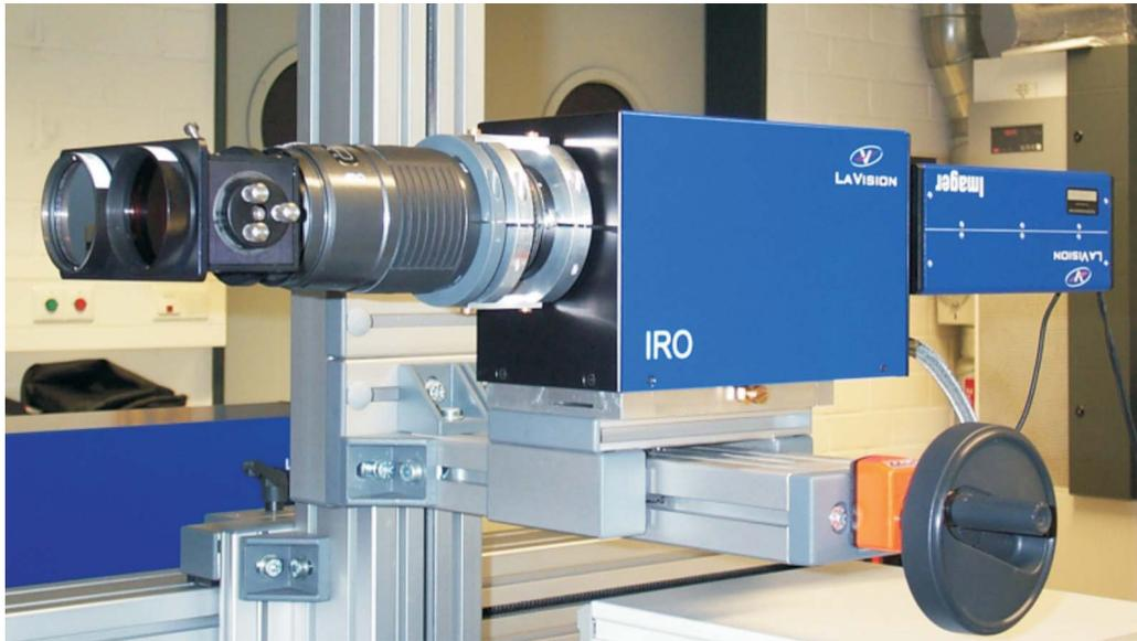
Bild 8.3: Foto von der CCD-Kamera mit Bildverstärkervorsatz, Doppelbildoptik und optischen Filtern
