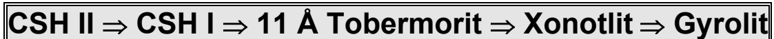
Abb. 4: Reaktionsschema der CSH-Phasenbildung bei der industriellen Autoklavbehandlung von Kalksandstein-Produkten ab 160°C (Mörtel, 1978)
