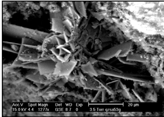
Abb. 66: ESEM-Abbildung des Kalksand-Preßlings mit Quarzsand [ \leq 0,30 mm] (C/S=0.53)
