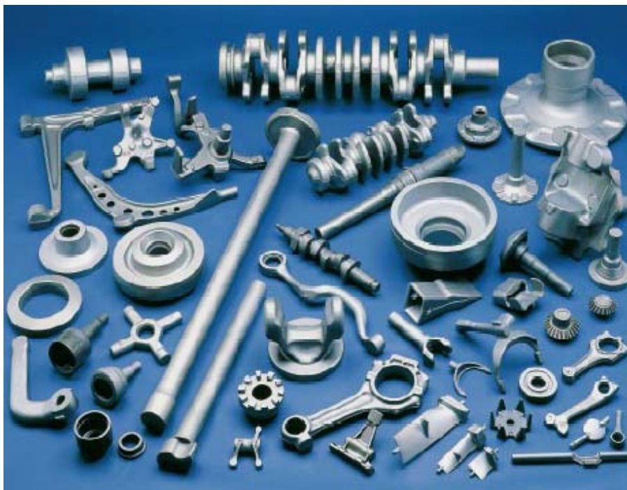
Bild 1.1: Spektrum schmiedetechnisch hergestellter Bauteile [IDS02]
