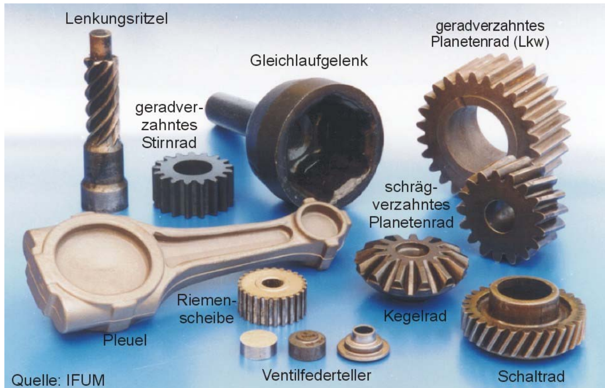
Bild 2.5: Am IFUM und IPH präzisionsgeschmiedete Bauteile
