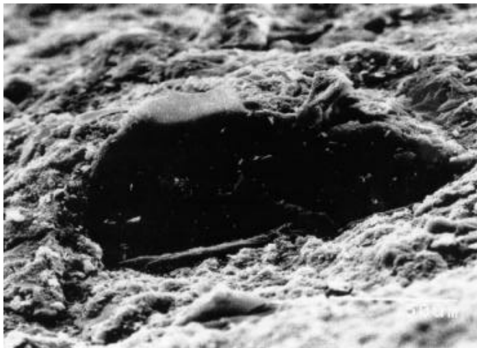
Abbildung 40: REM-Aufnahme eines möglichen Ferritkorns der mit Paste 2 behandelten Oberfläche
