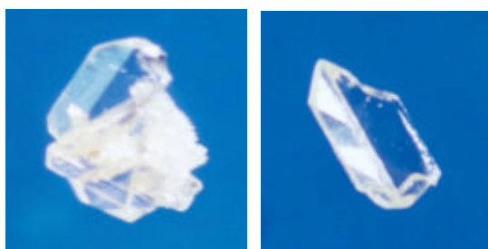
Abb. 5-13: Durch Chemischen Transport dargestelltes \text{In}_2\text{Ge}_2\text{O}_7 .
