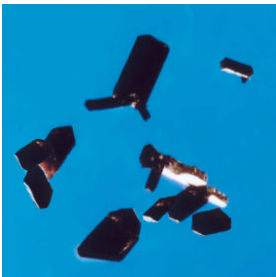
Abb. 5-11: Durch Chemischen Transport dargestelltes V_3GeO_7 .
