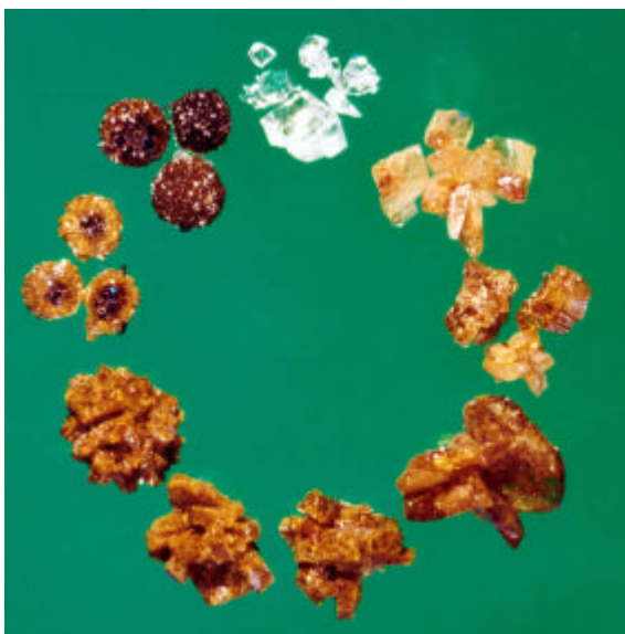
Abb. 7-5: Durch Chemischen Transport dargestelltes (Fe, In)_2Ge_2O_7 .
