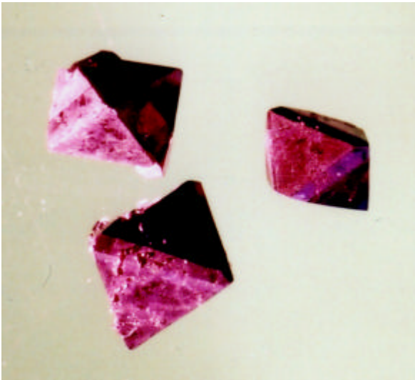
Abb. 6-8: Durch Chemischen Transport dargestelltes (Ni, Co)_2GeO_4 .
