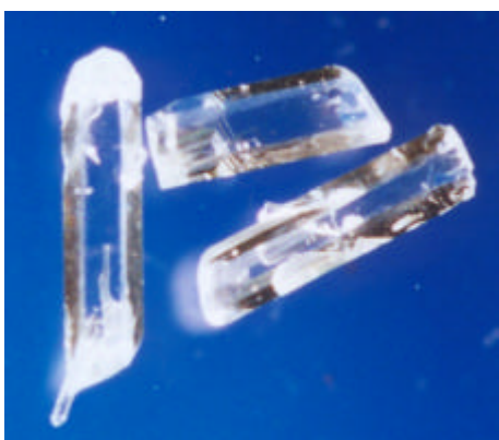
Abb. 5-10: Durch Chemischen Transport dargestelltes Zinkgermanat ( \text{Zn}_2\text{GeO}_4 ).
