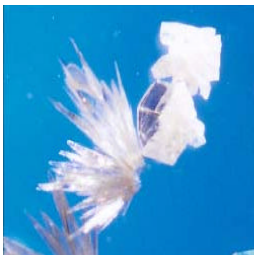
Abb. 7-7: Durch Chemischen Transport dargestelltes Ga_2Ge_2O_7:In^{3+} (links) und In_2Ge_2O_7:Ga^{3+} (rechts).
