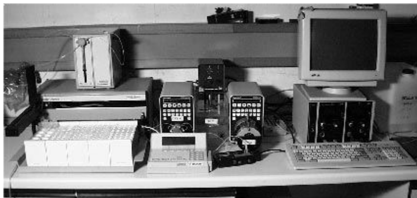
Abb. 6.1: V.l.n.r. Autosampler, Injektor, Wasserbad, Pumpe, Photometer, PC, vorne die Steuereinheit des Autosamplers und die Durchflußküvette
