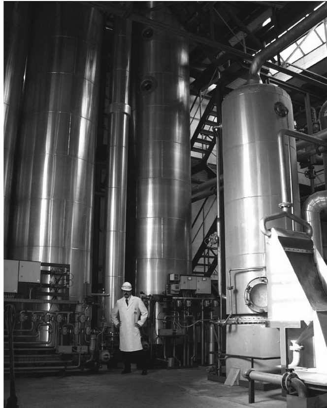
Abb. 4.2: Trennsäulen zur weiteren chromatographischen Aufreinigung der gewonnenen Fraktionen.
