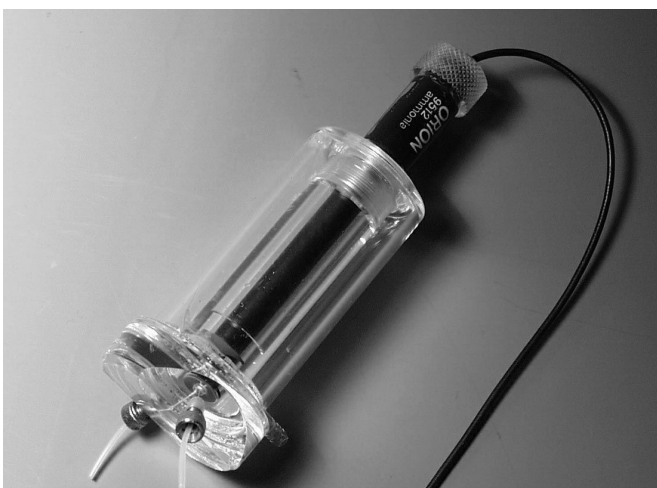
Abb. 14: Orion 9512 Ammoniak- elektrode in einer Durchflußzelle [53]
