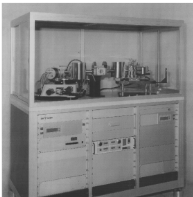
Abb. 2.1.3. STOE Transmissions-Diffraktometer-System Stadi P (Stoe Automated Diffractometer for Powder) als Gesamtansicht mit der dazugehörigen Strahlenschutzeinheit (Glaskasten) [31].
