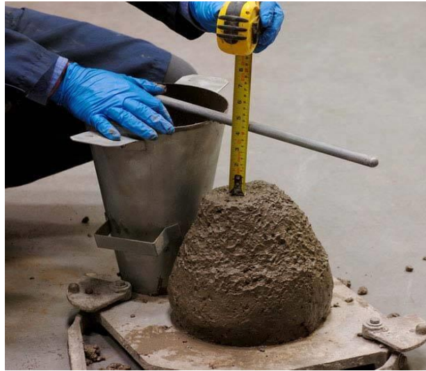
Figura 14. Prueba de Slump.
