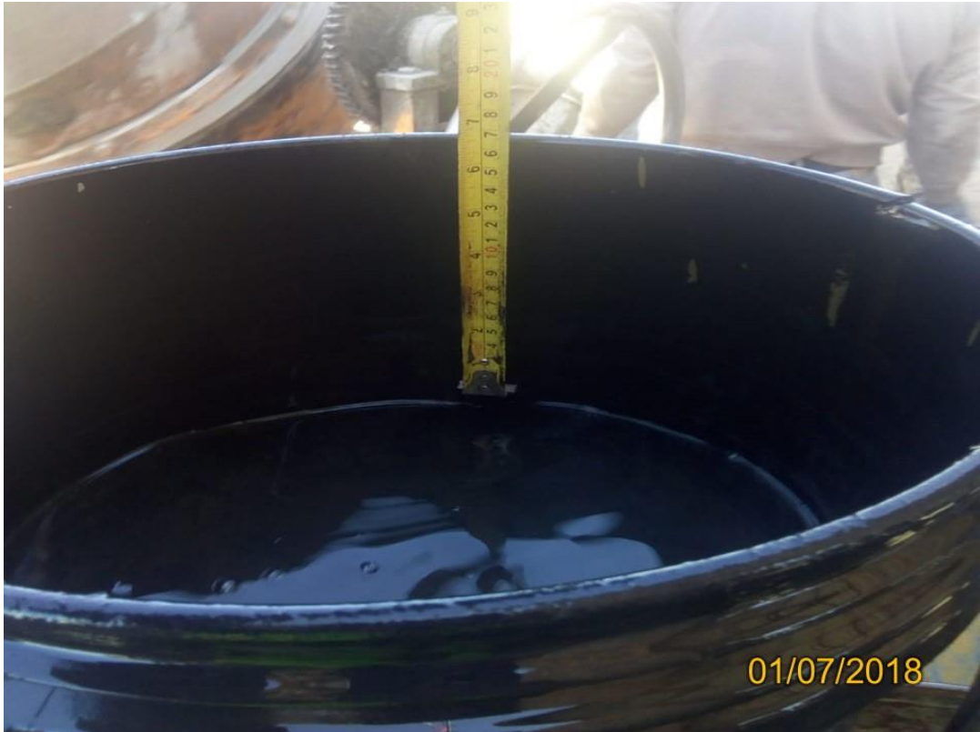
Fotografía 7. Medición de la lámina de agua del medio de medición de agua en el Jr. Las Auroritas S/N - Cajamarca.
