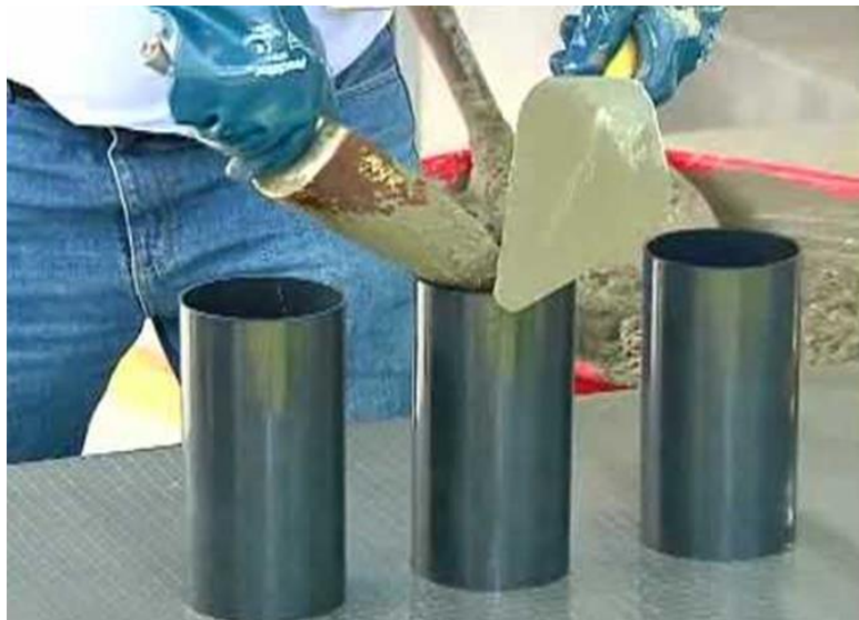
Figura 15. Elaboración y terminado de probetas cilíndricas.
