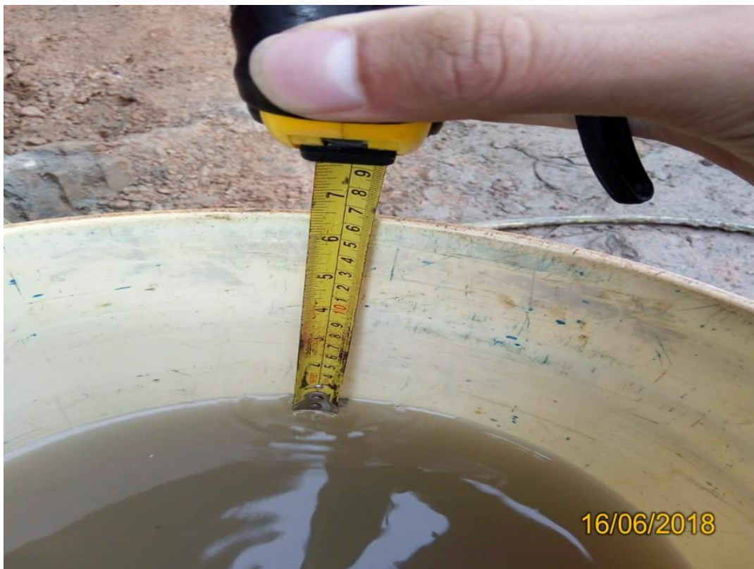
Fotografía 8. Medición de la lámina de agua del medio de medición de agua en el Von Jumbolt C3 - Cajamarca.
