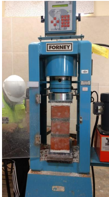
Fotografía 13: Ensayo de compresión de pilas
