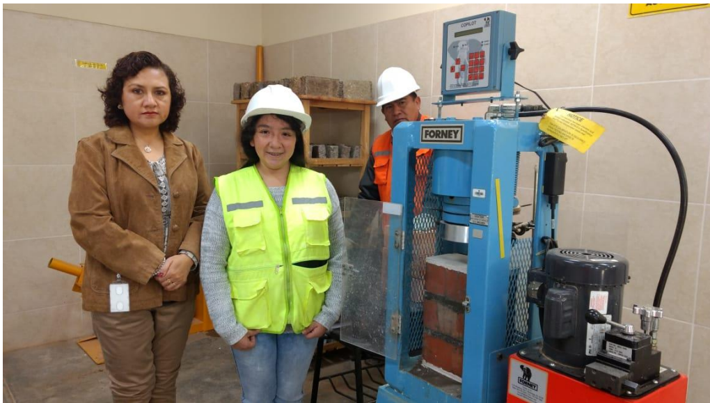
Fotografía 16: Ensayo a compresión de pilas
