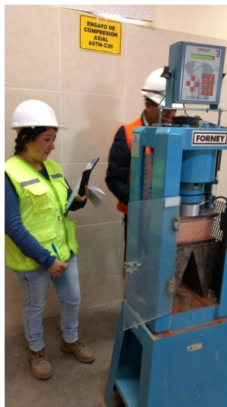
Fotografía 8: Ensayo de Compresión
