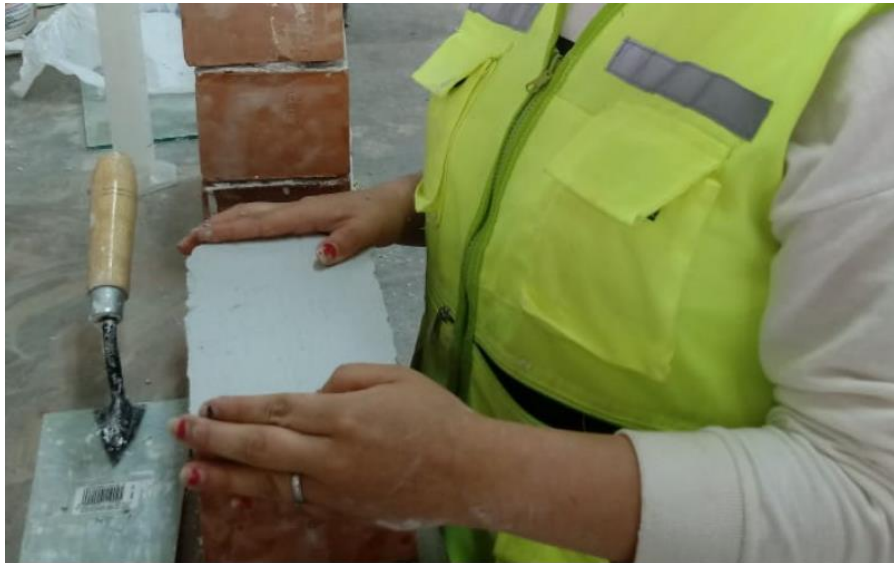
Fotografía 7: Espécimen de albañilería posterior al refrentado
