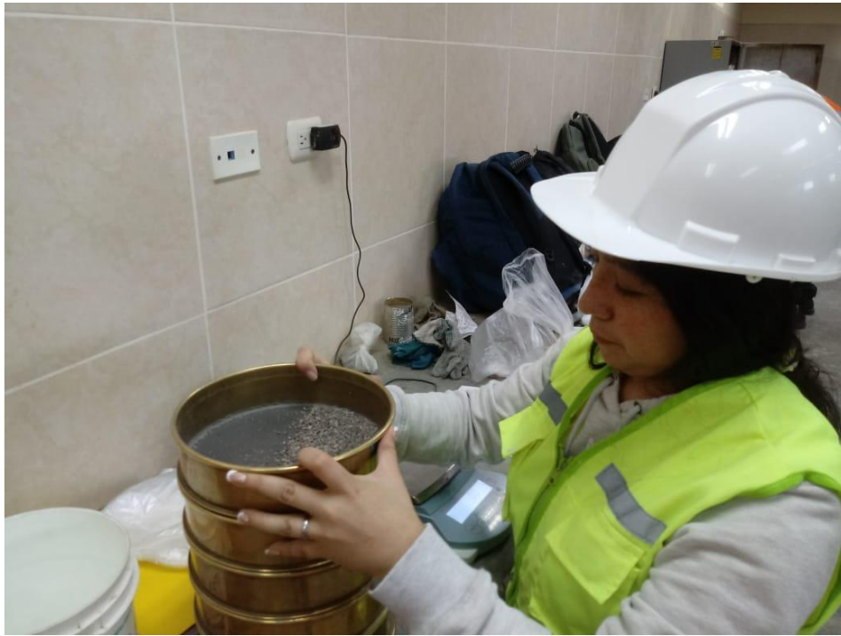
Fotografía 9: Ensayo de granulometría
