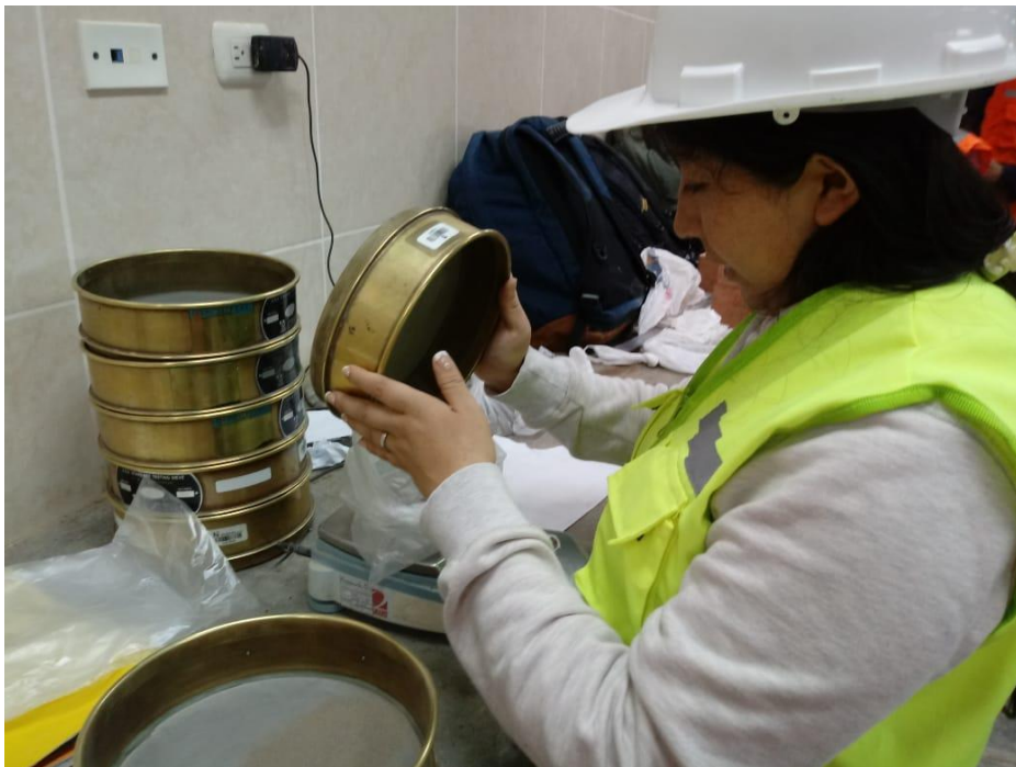
Fotografía 10: Peso del agregado retenido en cada tamiz
