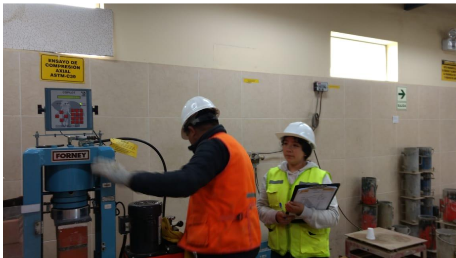
Fotografía 14: Ensayo de compresión
