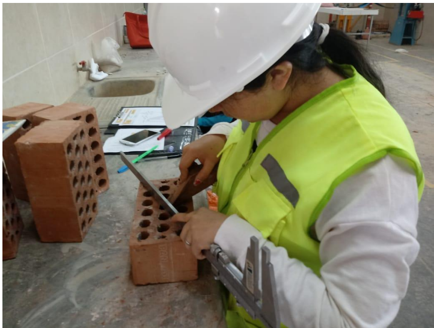
Fotografía 2: Ensayo de Alabeo
