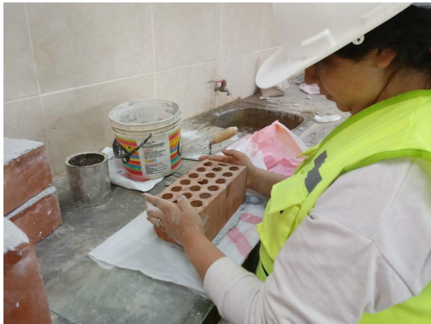
Fotografía 6: Refrentado de unidades de albañilería
