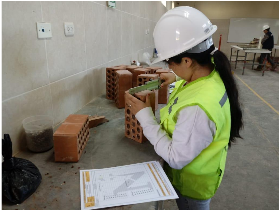
Fotografía 3: Ensayo de Variación Dimensional
