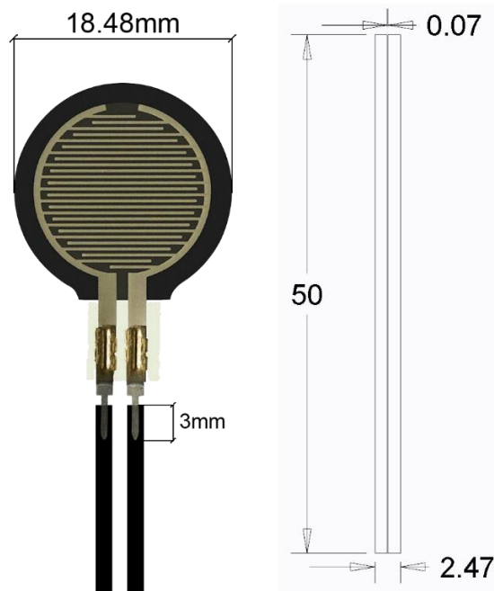
Ilustración 24 - Medidas de inserción en probeta y dimensiones en la misma
