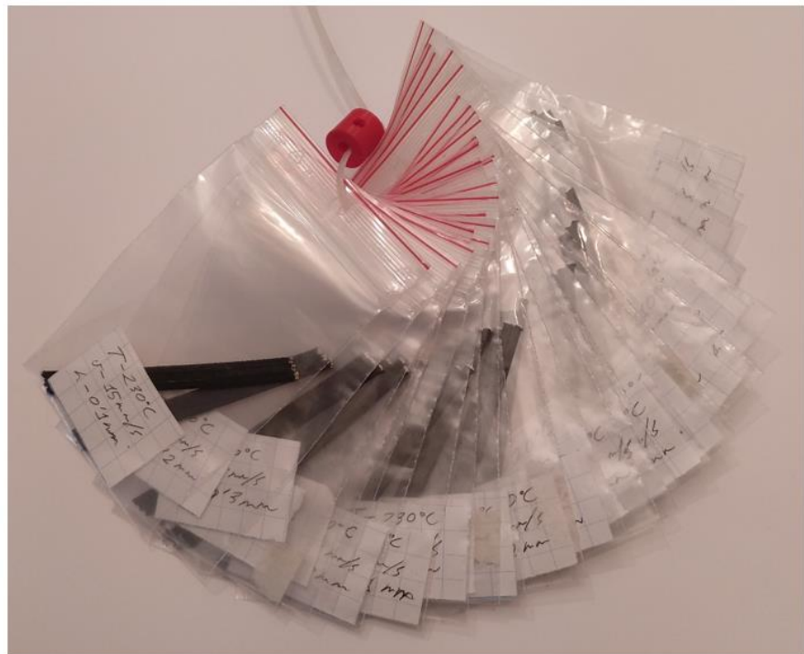
Ilustración 14 - Probetas de conductividad: temperatura, velocidad y altura de capa
