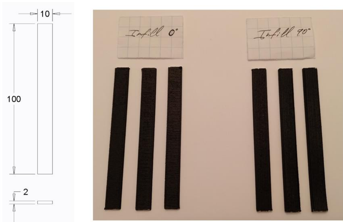
Ilustración 13 – Probetas de conductividad - Infill
