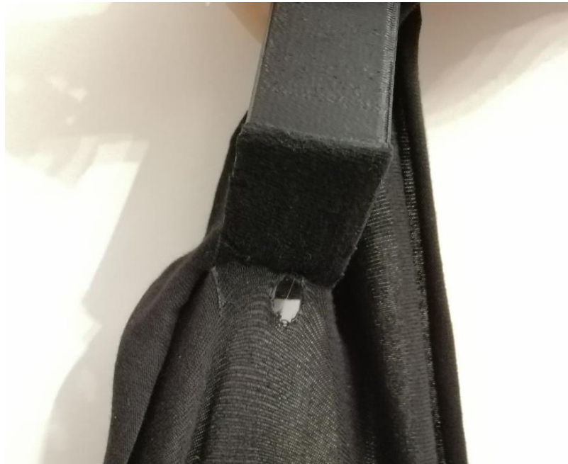
Ilustración 52 - Rotura de la tela en el ensayo de adherencia
