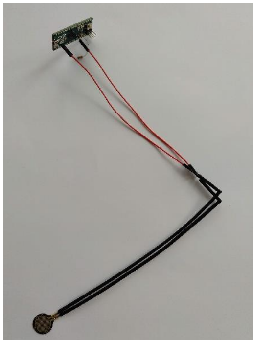
Ilustración 43 - Conexión del sensor con la placa Arduino mediante pistas impresas
