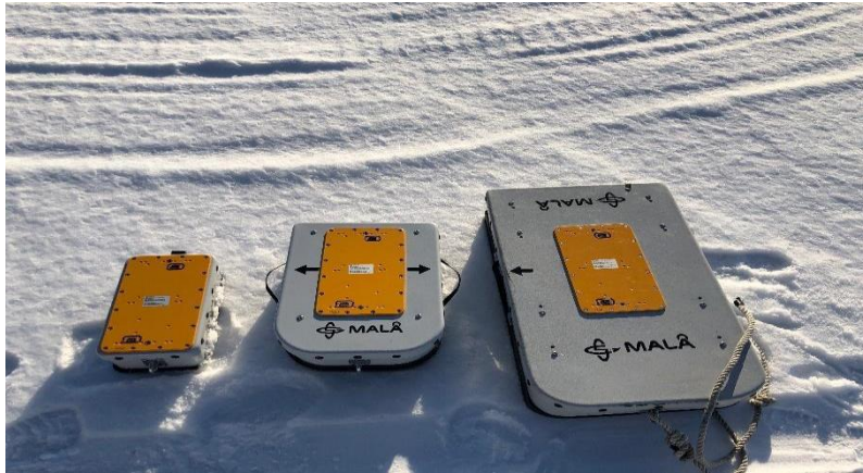
Figur 4: Bild på de använda antennerna. 800 MHz till vänster, 500 MHz i mitten samt 250 MHz till höger. Foto: Julia Cederbrant.
