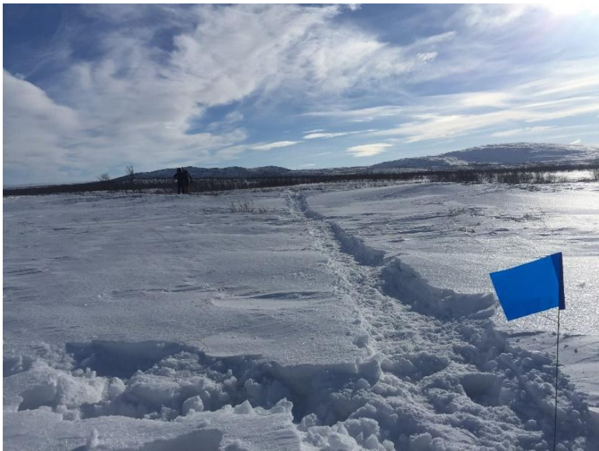
Figur 7: En profil utmarkerad med flaggor och tillplattad med hjälp av snöskor för att göra underlaget bättre för antennen att glida på. Foto: Madison Foot
