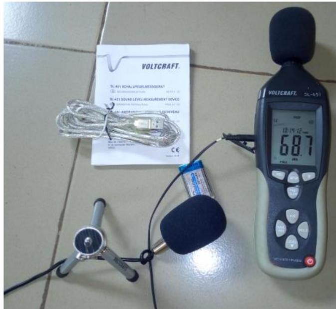
*Figure 4.6 : Image du sonomètre Voltcraft et ses accessoires*
