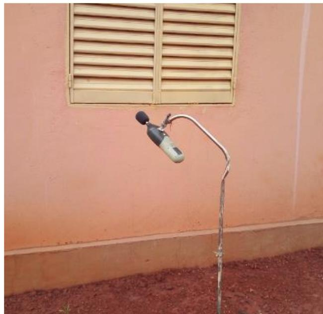
*Figure 4.8: Capteur de mesure acoustique installé à l'extérieur du bâtiment*
