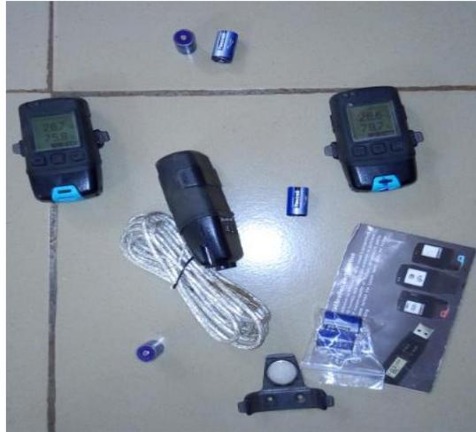
*Figure 5.5: Images des capteurs thermo hygromètres EasyLog GFX (Data Logger), accessoires et batteries de rechanges*
