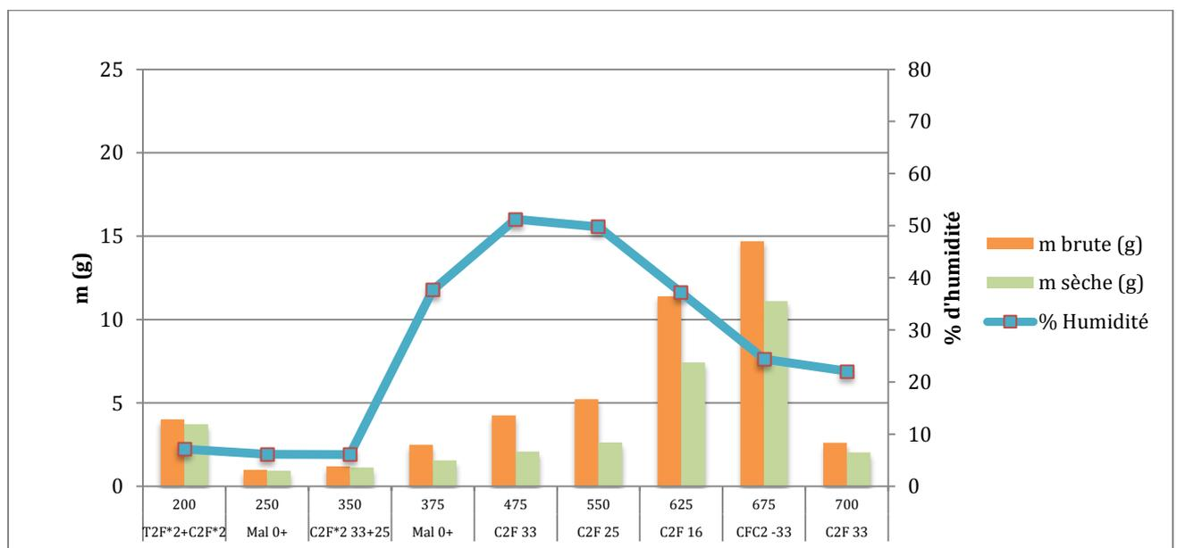
Figure 52 : Répartitions massiques en solides sec et humide et teneur en humidité du solide : profil 8
