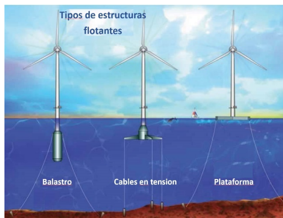
Figura 1: Diseños de turbinas flotantes.
