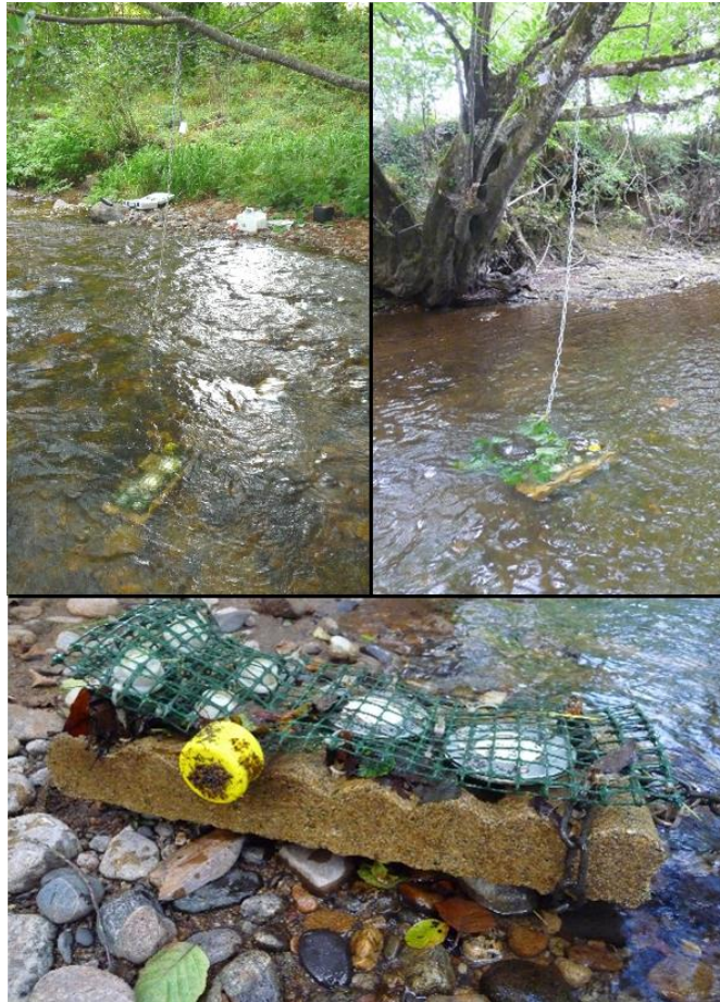
Figure II.28 : Échantillonneurs passifs (POCIS et o-DGT) installés à plat sur une dalle.
