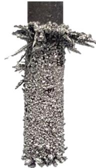
**Dépôt de Zr sur graphite avec une densité de courant moyenne et une concentration élevée**
