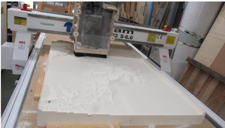
Procés d'elaboració del model topogràfic utilitzant una fresadora automatitzada
