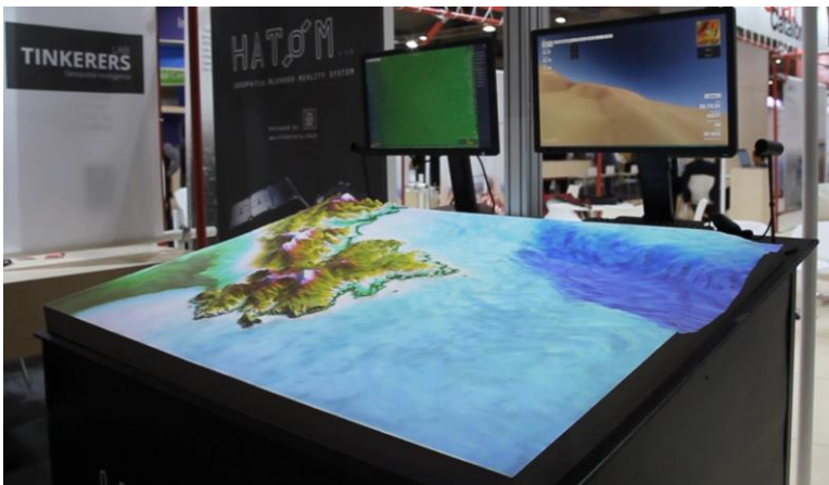
Prototip del HAToM de Cap de Creus. Mostra l'altimetria i batimetria de la zona.
