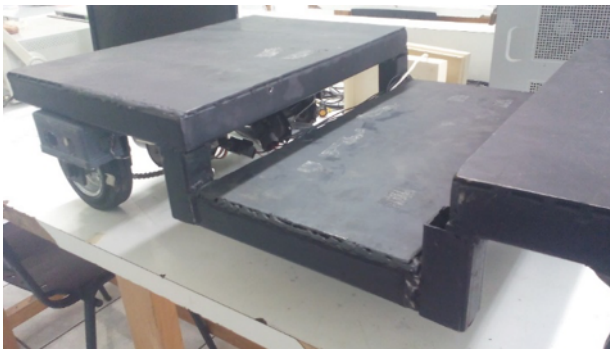
Figura 2. Área central del chasis, espacio para demás componentes.
