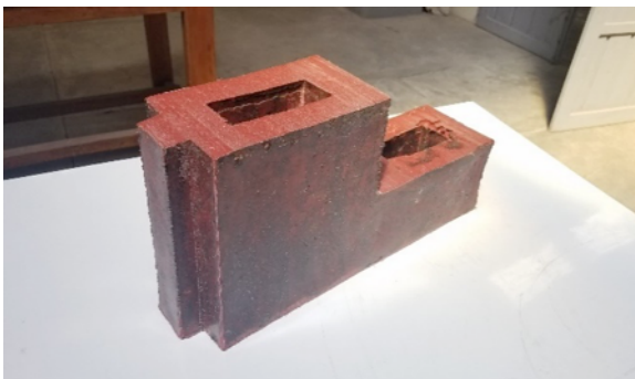
Figura 10. Prototipo de bloque de plástico reciclado de polietileno. Fuente: diseño propio, 2018
