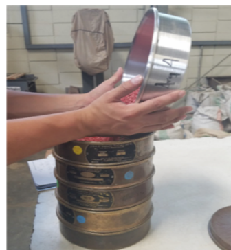
Figura 2. Muestra el tamizador utilizado para las pruebas de granulometría.
