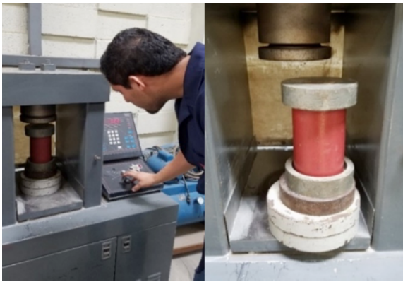
Figura 6. Probeta de plástico ensayada en la Máquina de Compresión.
