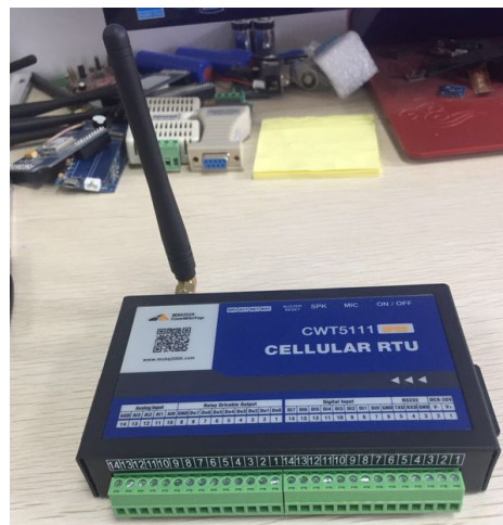
Figura 2. CWT5111 Data Logger GPRS RTU.
