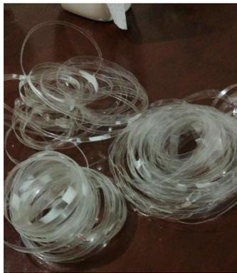
Figura 4: Botellas PET cortadas en rollos
