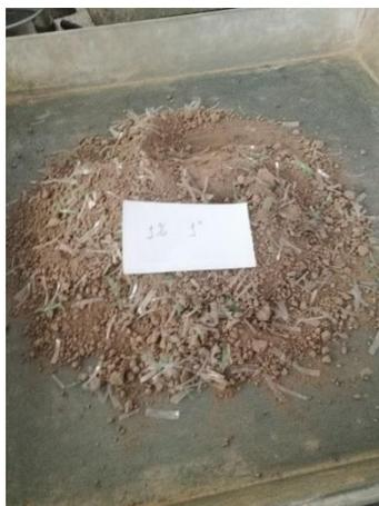
Figura 53: Suelo arcilloso con PET de 1" al 1%
