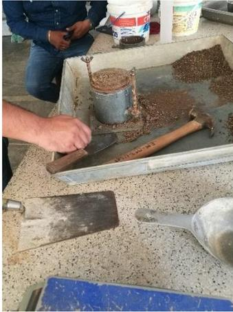
Figura 45: Ensayo de Proctor Modificado a Terreno Natural
