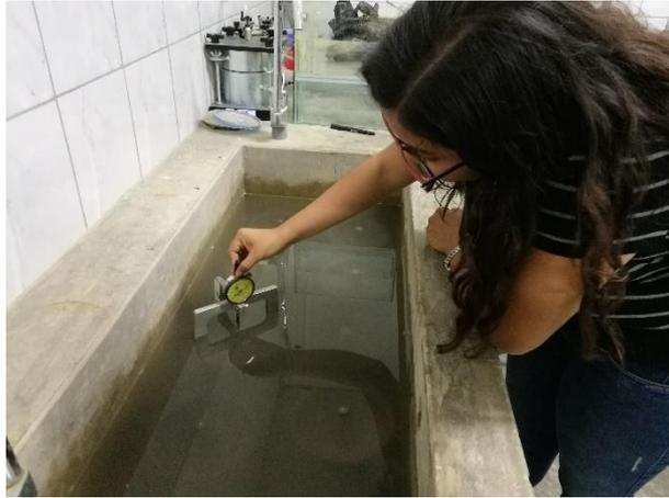
Figura 78 Medición de Asentamiento a las Muestras
