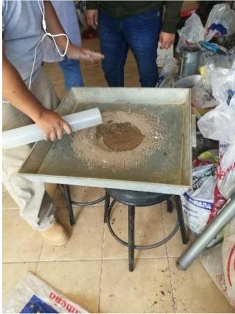
Figura 54: Mezclado con humedad del 10% para Proctor Modificado al 1% de PET de 1"
