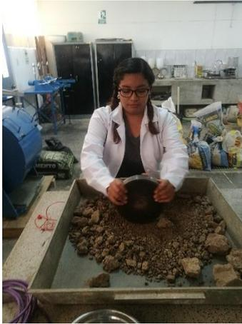
Figura 48: Preparación para Proctor Modificado
