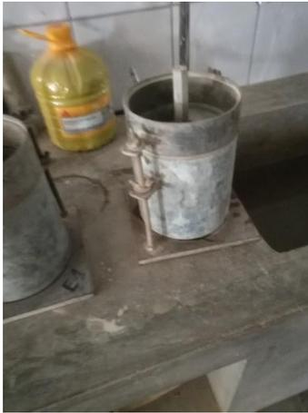
Figura 76 Muestra para ensayo de CBR lista para Sumergir
