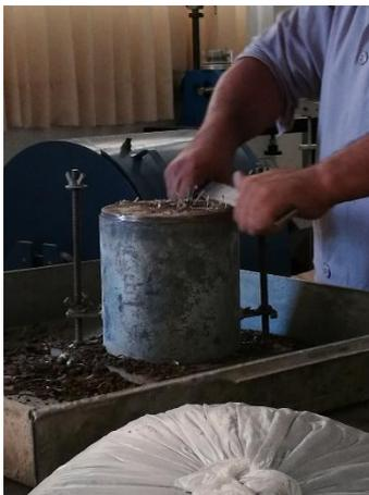
Figura 74 Ensayo de CBR a Terreno con Adición de PET de 1" al 1.15%
