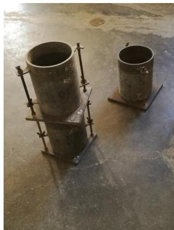
Figura 71 Moldes para ensayo de CBR
