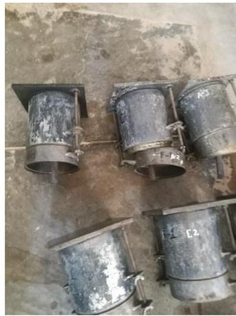
Figura 79 Muestras de CBR para Penetración
