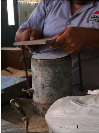
Figura 75 Preparación de Muestra de CBR para Sumergir
