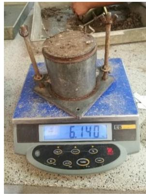
Figura 64 Molde de Proctor Modificado con PET 4" 1%
