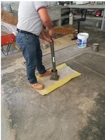
Figura 44: Compactación de Ensayo de Proctor Modificado de Terreno Natural
