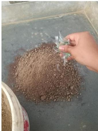
Figura 52: Mezclado de PET con suelo arcilloso
