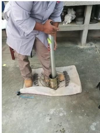
Figura 62 Ensayo de Proctor Modificado con PET 1" 2.5%
