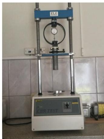
Figura 80 Máquina para Penetración de CBR
