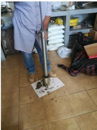
Figura 56: Compactación de Proctor de 1" al 1.5%
