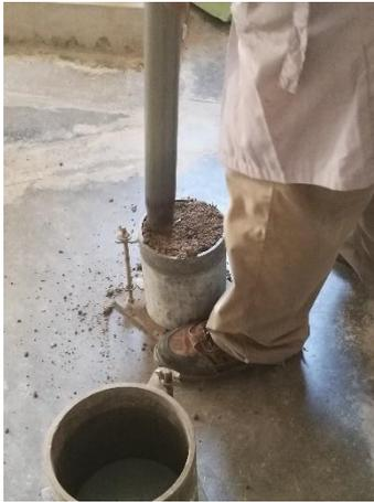
Figura 73 Compactación de Ensayo de CBR a Terreno Natural
