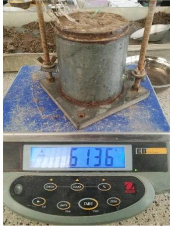
Figura 69 Molde de Proctor con PET 4" al 1.25%
