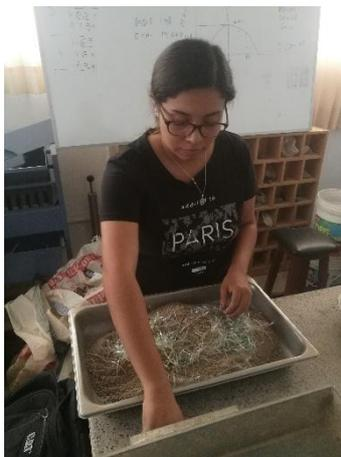
Figura 65 Preparación Mezcla con PET 4" 1.25%
