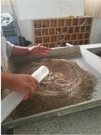
Figura 72 Proceso de Ensayo de CBR a Terreno Natural
