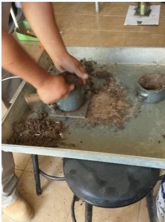
Figura 55: Ensayo de Proctor Modificado con 1" al 1%
