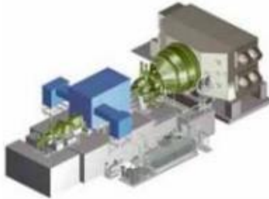
Figura 32: Turbina Siemens SST-700
