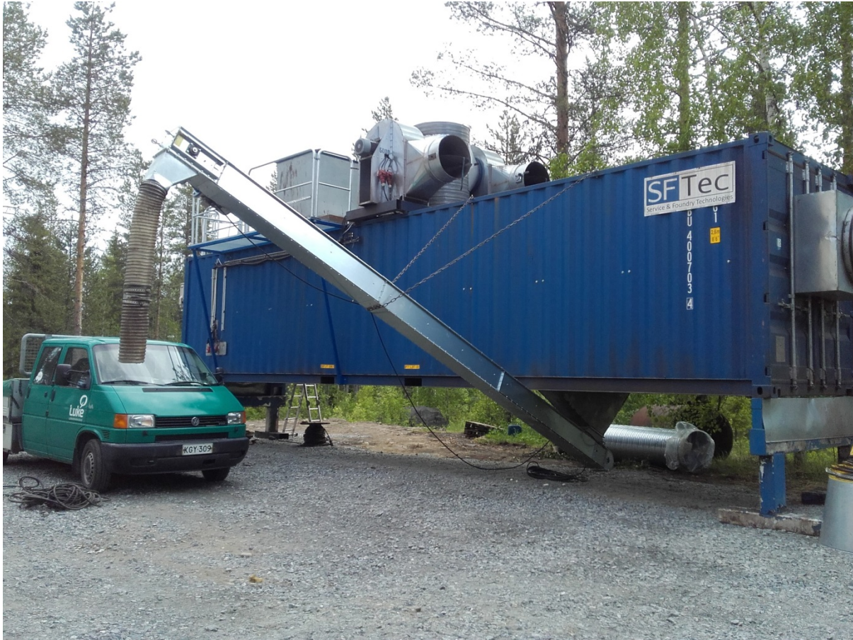
Kuva 8. Metsähakkeen keinokuivauksessa testattiin SFTec Oy:n valmistamaa konttikuivuria. Merikonttiin rakennettu kuivuri sopii useiden eri materiaalien kuivaukseen ja se on siirrettävissä kuivaustarpeen mukaan.
