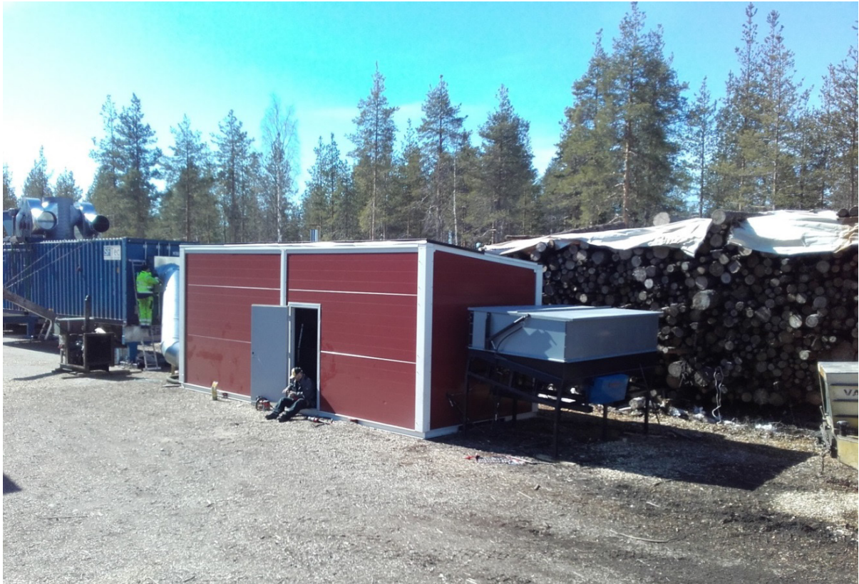
Kuva 9. Toukokuun 2017 koekuivauksissa kuivauksessa tarvittava lämpö tuotettiin hakkeella (hakekontti) ja tarvittava sähkö agrekaateilla.
