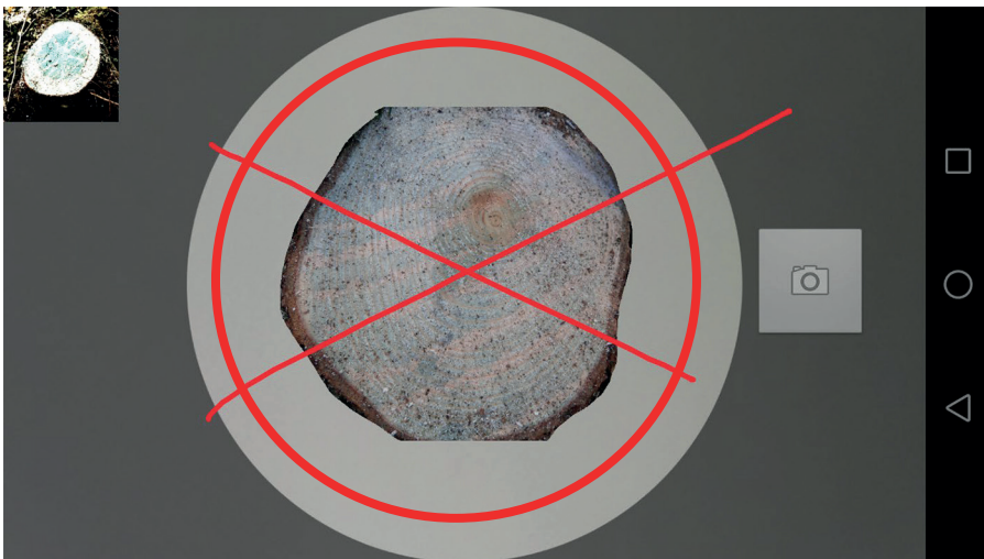
Kuva 2. Esimerkki liian kaukana kamerasta olevasta kannosta. Ainakin osa kannosta on oltava punaisen kehän ja ulkokehän välissä.
