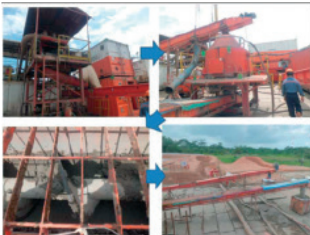
Slika 6. Tehnološki tijek krutog otpada od izdvajanja iz isplake do odlaganja u jamu za krhotine ili u vreće (Lesto & Kasumo, 2015)
