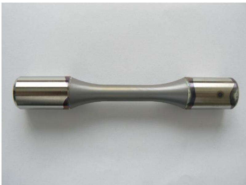
Figure II.26 : Photo d'une éprouvette de fatigue anodisée à 10°C, 20V, 2h.
