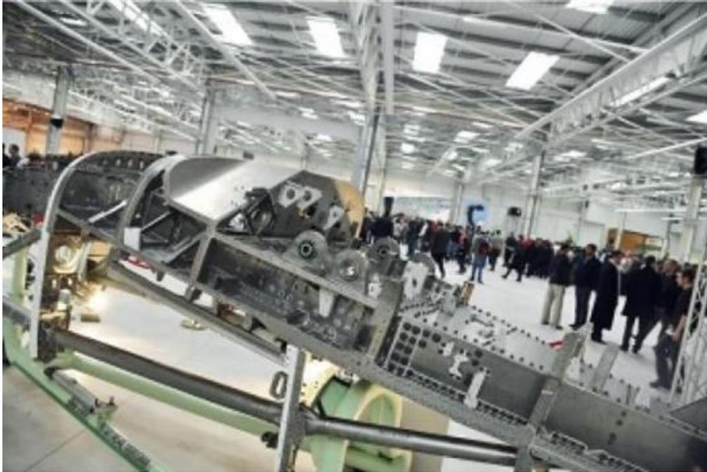
Figure 0.2 : Mat moteur en alliage de titane.
