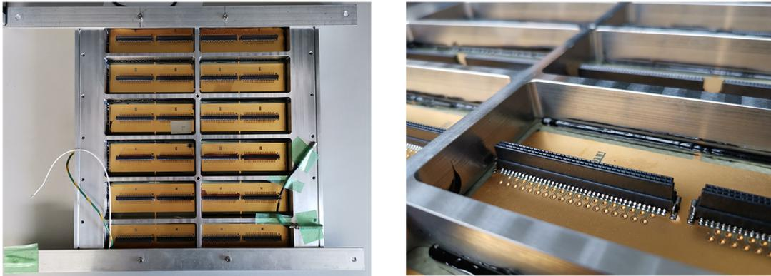
Figura 1.5: A sinistra una foto del retro della Micromegas MM0 DLC3, a destra il particolare del gruppo di pads D11
