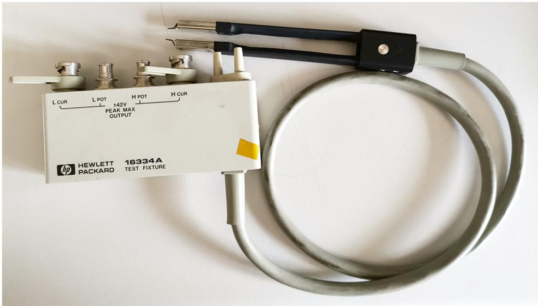
Figura 2.4: Una foto della sonda a "pinza" Keysight 16334A Test Fixture
