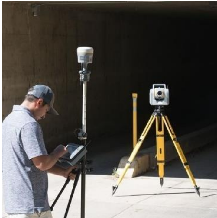
Ilustración 17 Detalle del receptor GNSS R10 colocado junto al prisma VX360 (Trimble)
