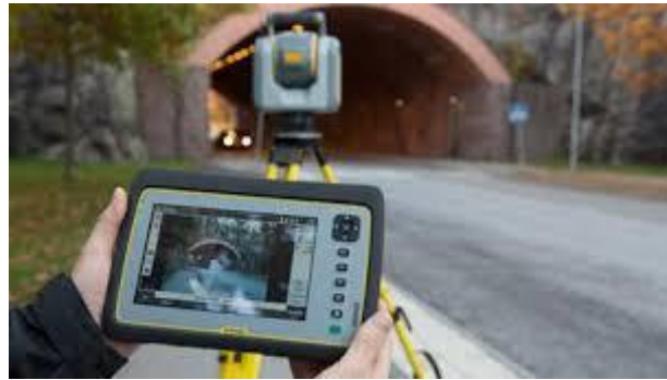
Ilustración 14 Tablet con la que se gestiona el equipo (Trimble)
