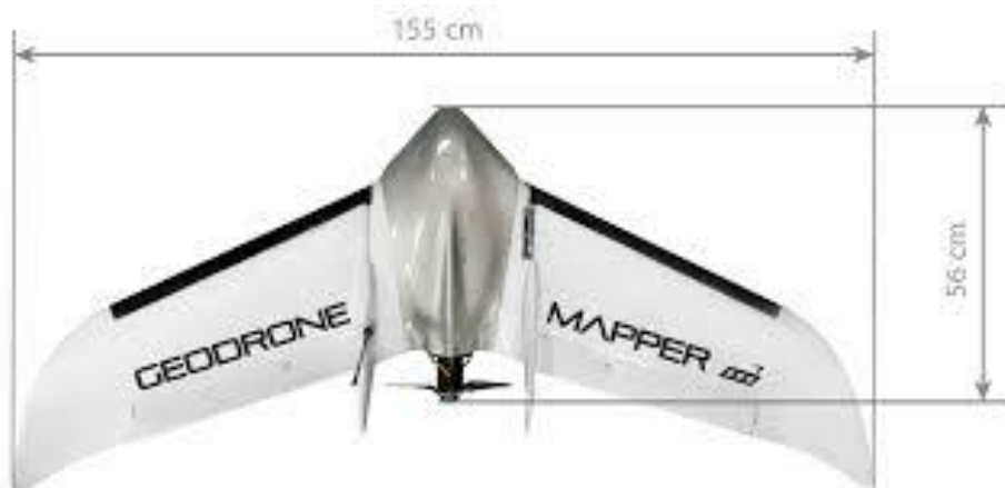
Ilustración 16 Dimensiones del aparato (Conyca Aero)
