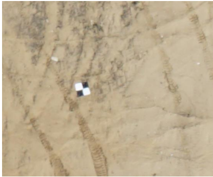
Ilustración 23 Panel colocado en el terreno para señalar un Punto de Control
