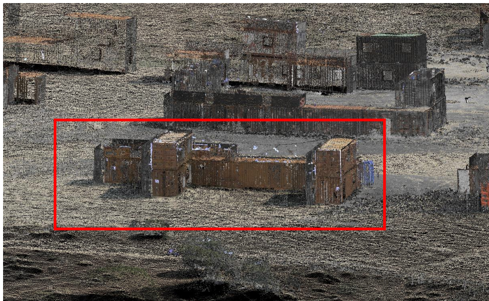
Ilustración 62 Unión de datos procedentes del GEODRONE, SX10 y V10 (fotogrametría terrestre)
