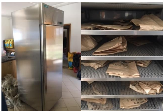
Slika 20: Zunanost in notranost peči za sušenje potaknjencev (Kovše 2018).
