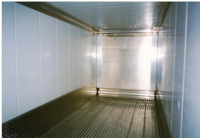
Slika 7: Notranjost hladilno - izolacijskega kontejnerja
