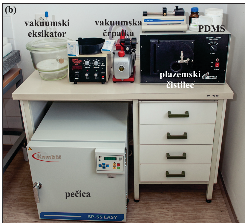
Slika 3.6: Mehka litografija. (a) Shematski prikaz postopka mehke litografije za izdelavo mikrofluidičnega čipa. (b) Laboratorijska oprema za mehko litografijo.
