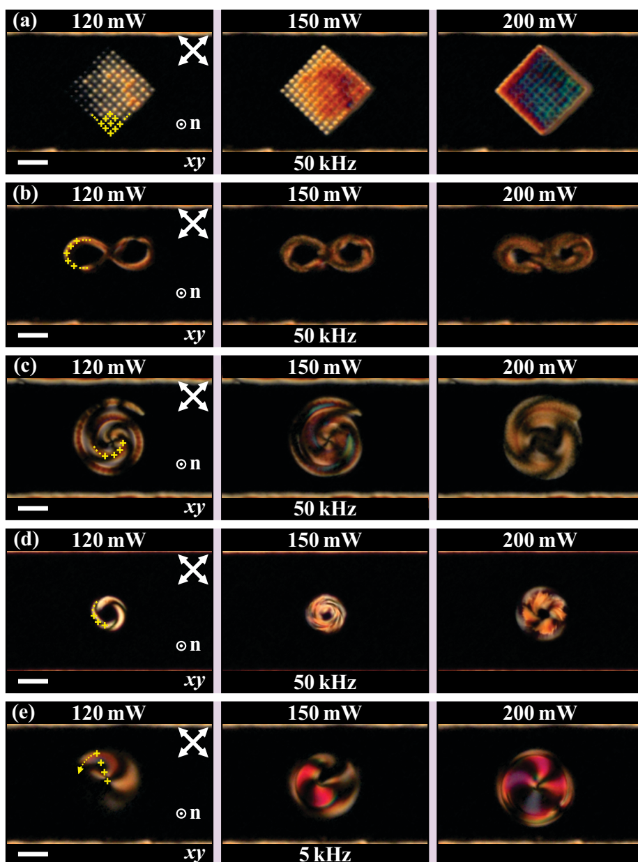
Slika 4.3: Sekvence točk optičnih pasti laserskega snopa v homeotropnem PDMS mikrofluidičnem kanalčku. (a) Kvadratna mreža, (b) znak \infty , (c) spirala, (d) krog iz 100 točk ter (e) vrteča se linija pri različnih močeh in frekvencah premika optične pasti. Merilo: 25 \mu\text{m} .
