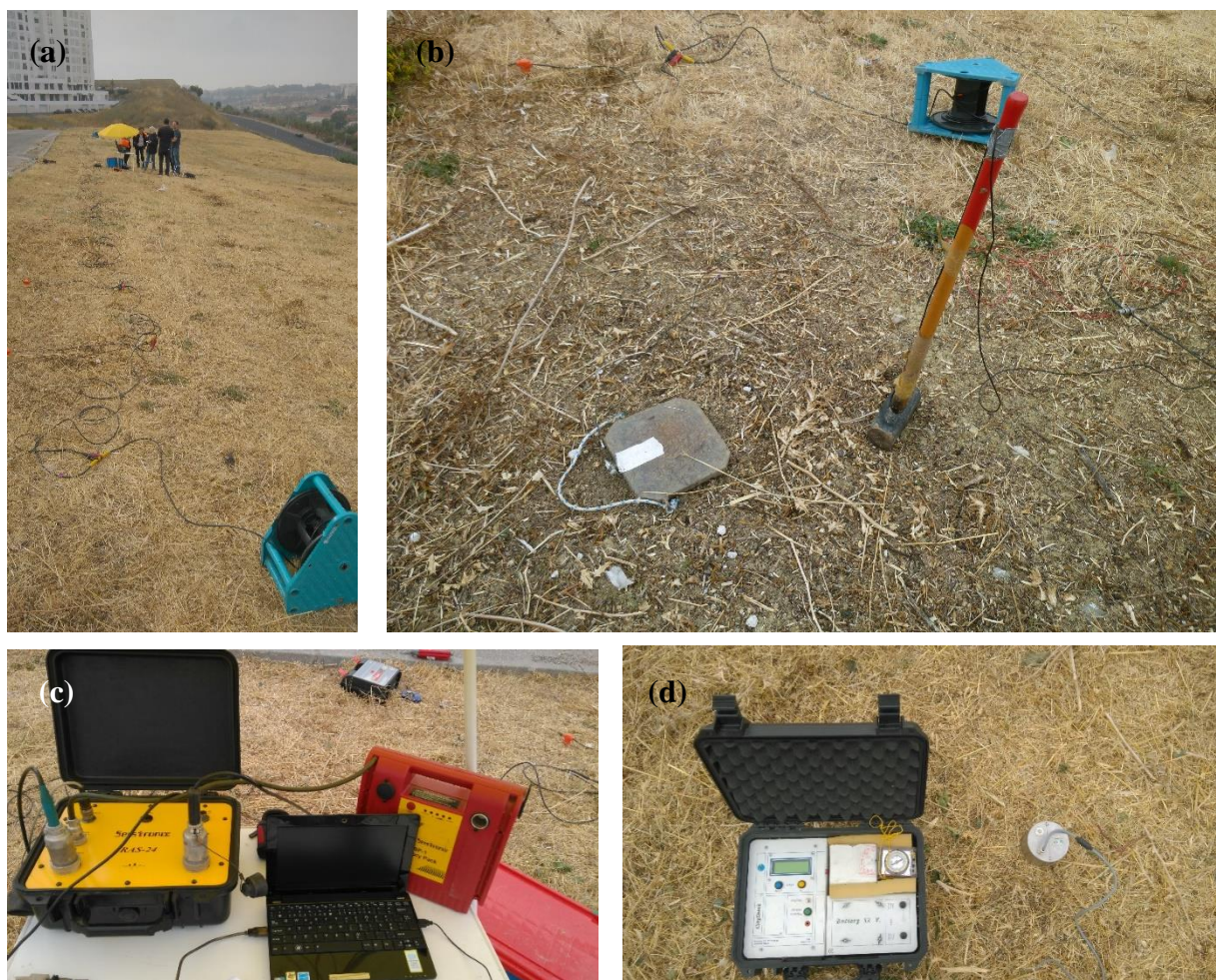
Figura 3.6- Montagem e material utilizado para a aquisição de dados em Chelas; a) Extensão da aquisição de dados e montagem dos geofones; b) Martelo utilizado como fonte de energia; c) Sismógrafo utilizado para a aquisição de dados (RAS-24 da Seistronix ); d) Estação única utilizada para gravar o ruído sísmico ( CityShark ).
