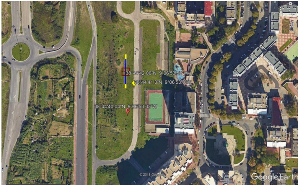
Figura 5.8- Localização, com as respectivas coordenadas, da aquisição H/V (ponto vermelho), de array linear (quadrado vermelho) e da sondagem geotécnica mais próxima (ponto amarelo). A aquisição em array foi feita usando 2 dispositivos diferentes: a amarelo com uma extensão de 48 m; a azul uma extensão de 36 m. As coordenadas foram tiradas no centro.
