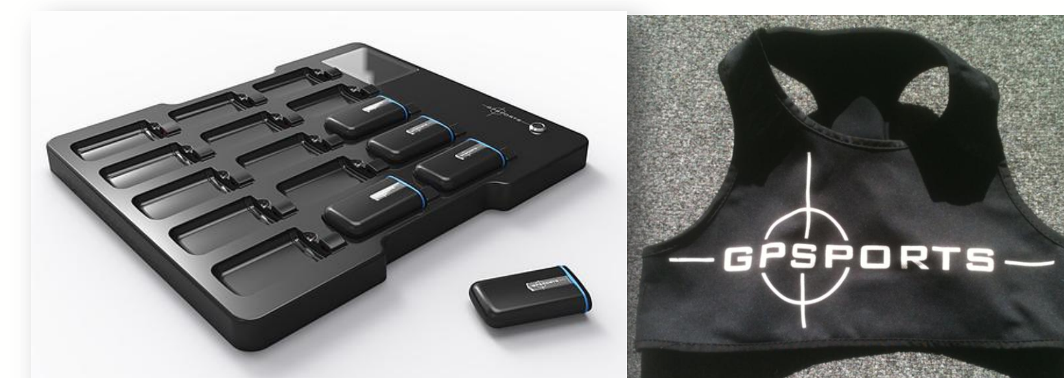
Imagen 1. Dispositivos GPS, central de carga de datos y chaleco portador.
