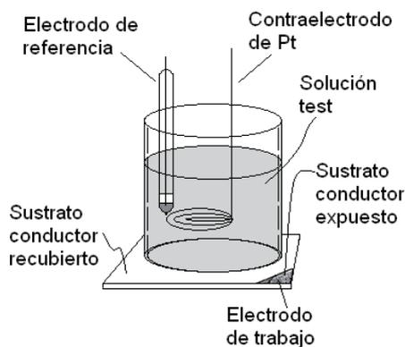
**Figura 1:** Celda electroquímica.
