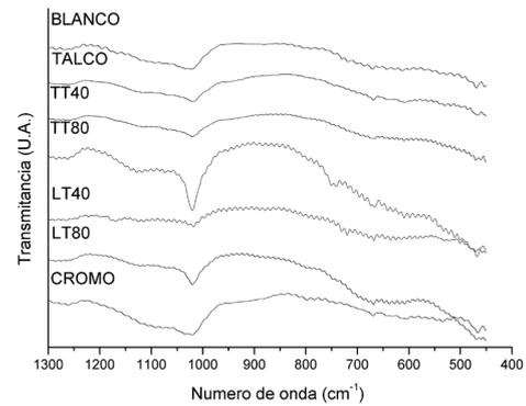
Figura 5: FTIR de los productos de corrosión.
