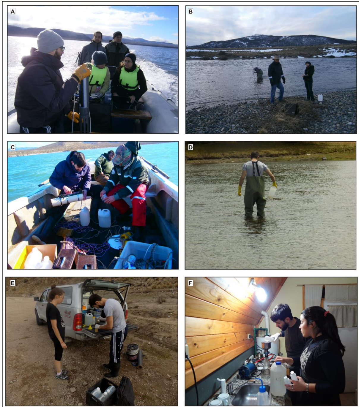
Figura 5.3. Métodos de muestreo, monitoreo, filtrado y almacenamiento. Sonda multiparamétrica YSI 6600 V2-4 en lago Fontana (A). Sonda multiparamétrica HORIBA U10® en la cabecera del río Senguer (B). Muestreo de agua con botella Van Dorn en lago Musters (C). Muestro de agua con bidón en el río Senguer (D). Acondicionamiento y almacenamiento del agua post muestreo (E). Filtrado de agua in situ (F).
