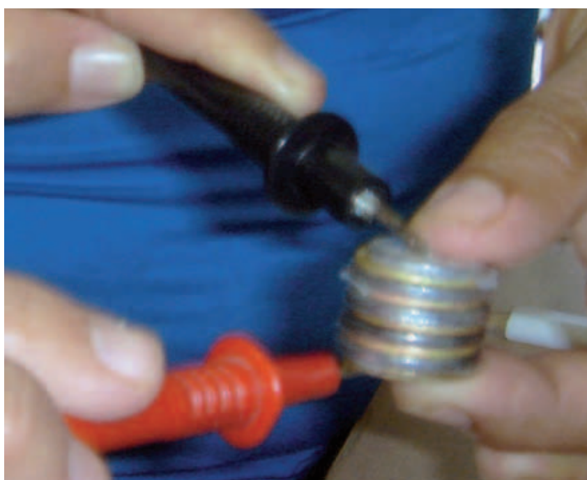
Figura 8. Midiendo el voltaje generado en la pila hecha con monedas peruanas (10 y 20 céntimos) y papel humedecido en agua con sal.
