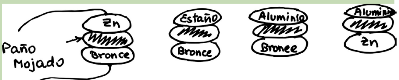
Figura 6. Apuntes del cuaderno de un profesor cuya pregunta hacía referencia a cambiar el material de los discos y medir el voltaje generado.
