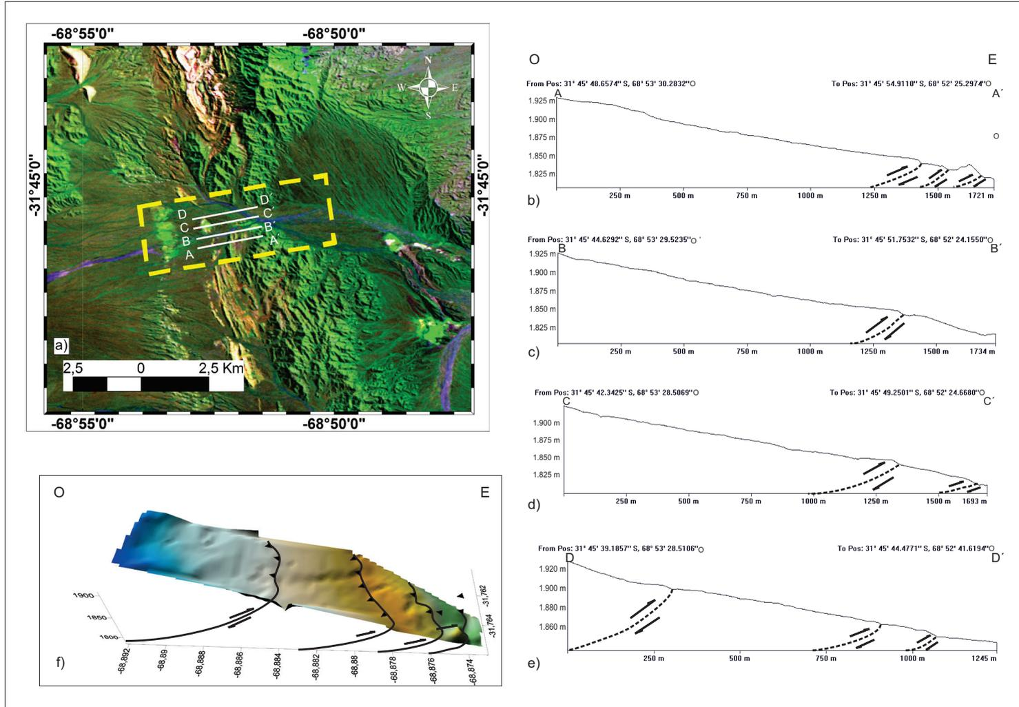
FIG. 6. **a.** Imagen con la ubicación de los Perfiles construidos con GPS diferencial de sur a norte: A-A', B-B', C-C' y D-D'; **b-e.** Estos perfiles muestran los cambios de pendiente que se relacionarían con fallas reconocidas en el campo y/o inferidas, las que generaron los resaltos topográficos y que no cortan la superficie; **f.** DEM generado a partir de los perfiles y ubicación de las estructuras ciegas.
