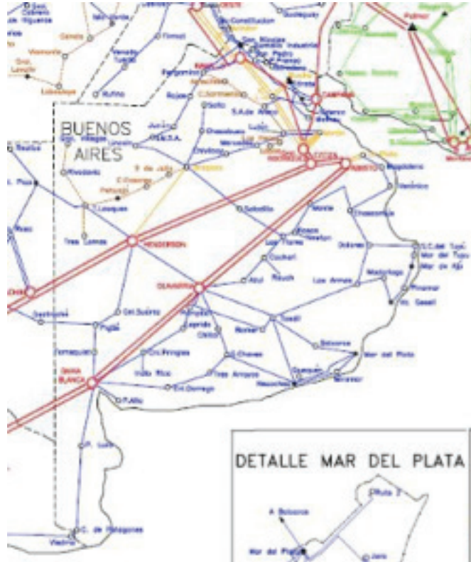
Fig. 7. Líneas de alta tensión
