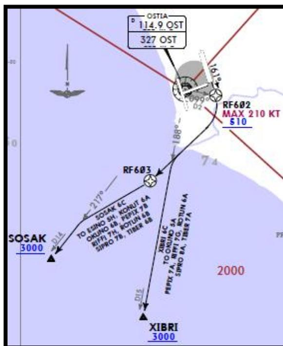
Figura 29. SID para despegue por pista 16L.
