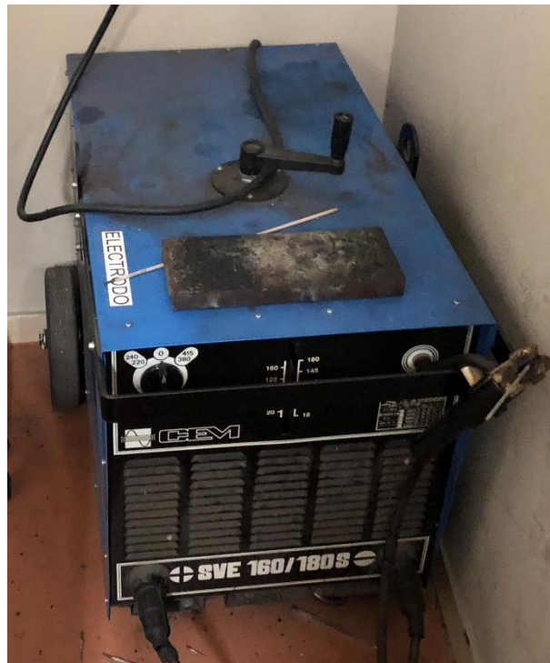
Imatge 23.- Soldadura per elèctrode revestit
