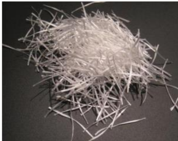
Ilustración 1.2.2 Fibras de polipropileno. Fuente: Comportamiento Mecánico del Hormigón Reforzado con Fibra de Polipropileno Multifilamento: Influencia del Porcentaje de Fibra Adicionado. Fernando Muñoz Cebrián, 2011
