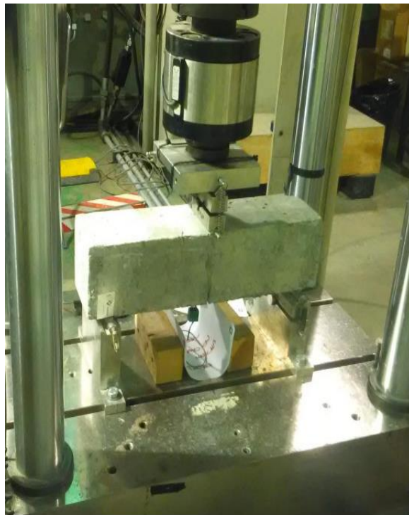
Ilustración 1.3.1 Ensayo a tracción del hormigón. Fuente: Laboratorio de estructuras UPC
