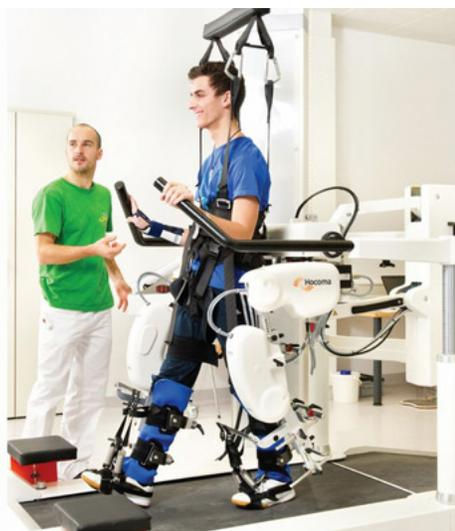
**Figura 2-9:** Dispositivo de rehabilitación robótica estático LOKOMAT
