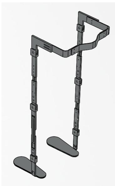
Figura 4-1: Modelo del exoesqueleto H1 creado en *SolidWorks*
