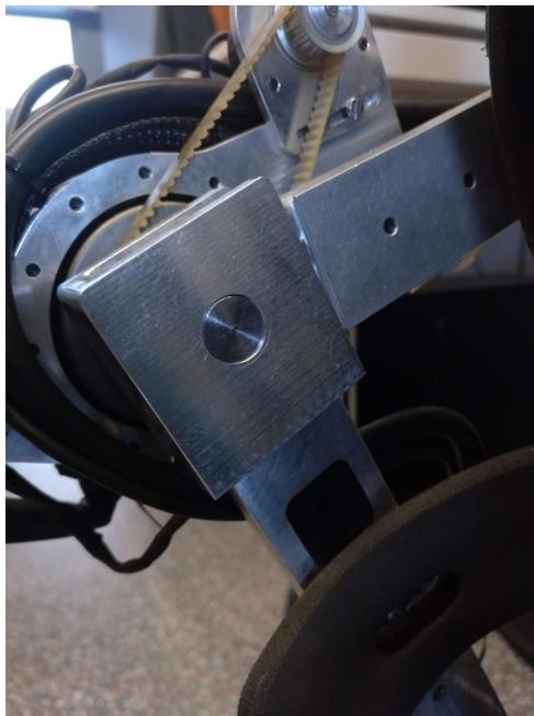
**Figura 3-9:** Articulación media del exoesqueleto H1, tipo horquilla.
