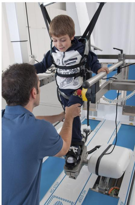
**Figura 2-11:** Dispositivo de rehabilitación robótica de tipo erector final G-EO SYSTEM™.
