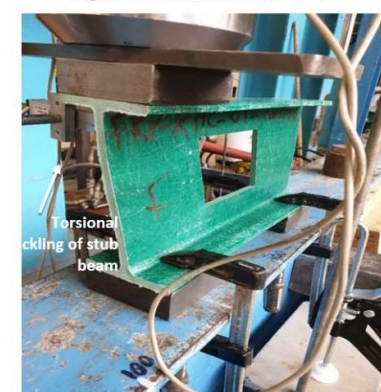
Fig. 19. Failure mode FRP-RHC-Co 4.
