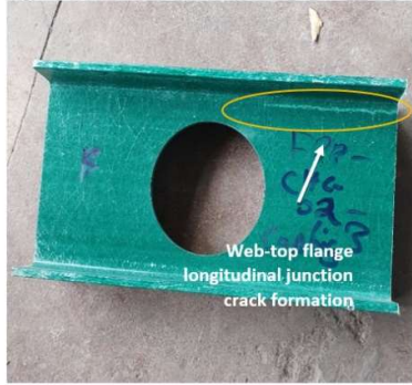
Fig. 14. Failure mode FRP-CHC-Co 3.
