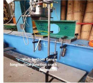
Fig. 15. Failure mode FRP-CHC-Co 4.
