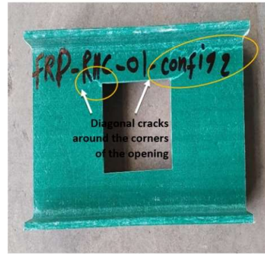
Fig. 17. Failure mode FRP-RHC-Co 2.
