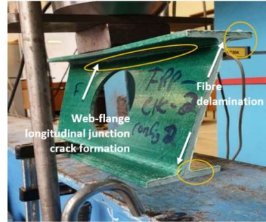
Fig. 13. Failure mode FRP-CHC-Co 2.
