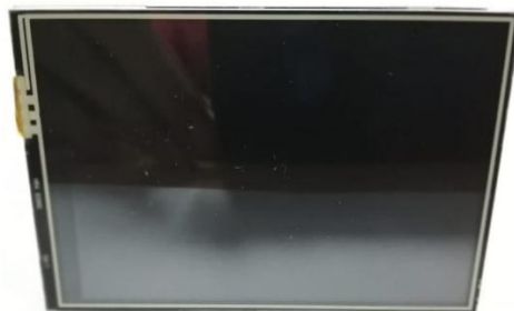
Ilustración 16. Pantalla táctil TFT 3.5" de 320x480 pixeles para Raspberry Pi
