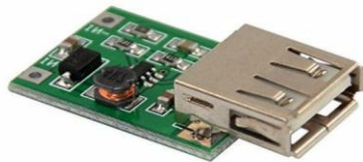
Ilustración 25. Módulo step up booster DC-DC
