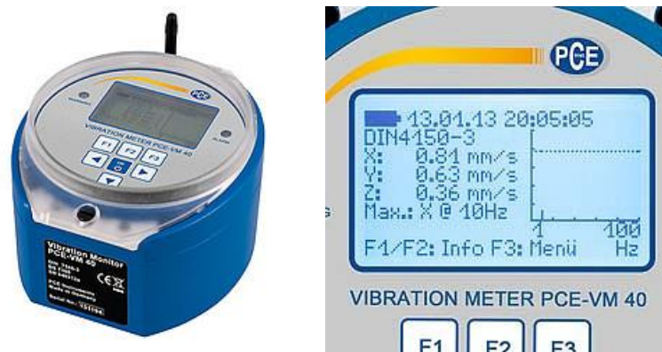
Ilustración 47. Medidor de vibración PCE-VM con pantalla LCD
