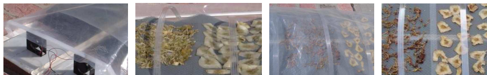
Figura 3: Secador solar portátil, con ventiladores. Lecho de producto puesto a secar con distintos cortes.
